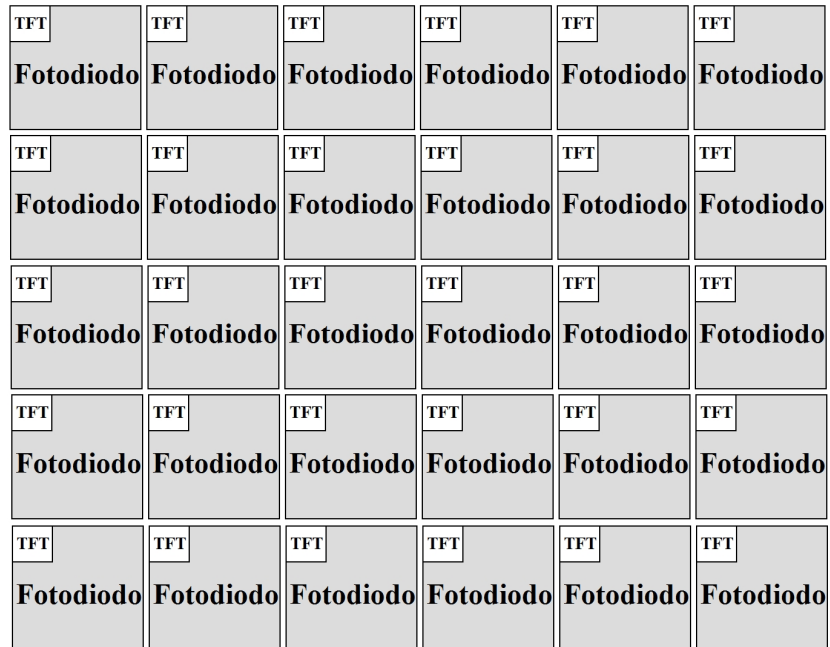
Figura 2.26 – Arranjo de pixels compostos por Fotodiodos e TFTs na matriz de detector digital.
