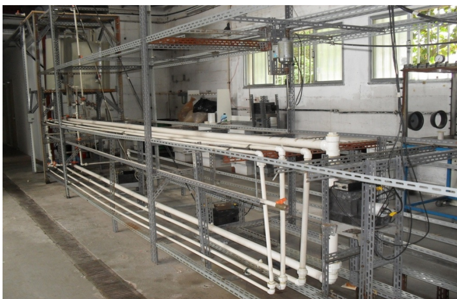
Figura III.1 – Linhas de transporte para compostos orgânicos instaladas no laboratório.
