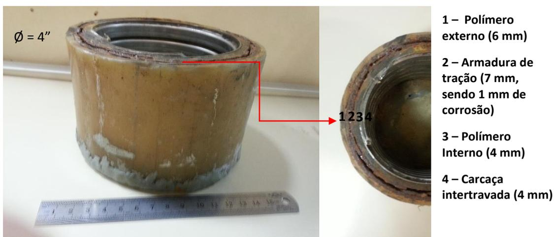
Figura III.3 – Amostra 3: *Riser* flexível (vista frontal e superior).
