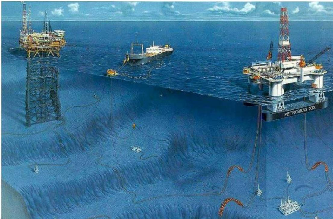
Figura A2.1: Sistemas de produção de petróleo "*offshore*" (da esquerda para a direita temos: Plataforma fixa, Navio de produção FPSO e Plataforma semi-submersível) (MARTINS, 2008).
