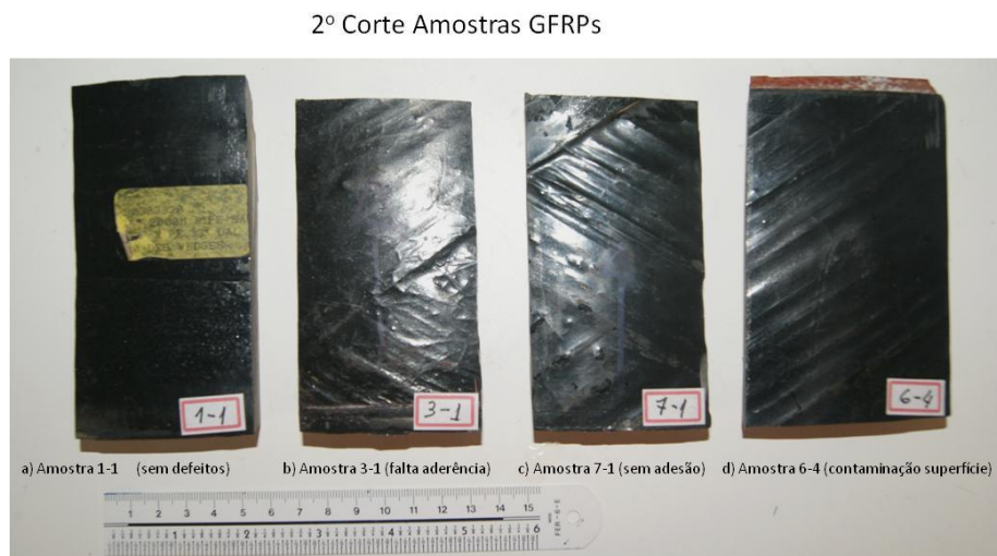
Figura 6 – Exemplificação dos corpos de prova de GFRPs inspecionados por RD e Micro-CT.
