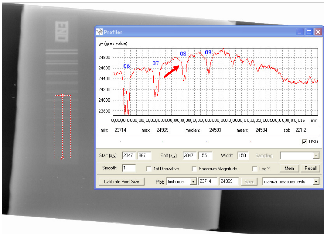
Figura 4-15 - Imagem radiográfica computadorizada do CP A7 utilizando fonte de raios \gamma , mostrando a BSR de 160 \mu\text{m} no sentido paralelo ao laser de leitura do escâner.
