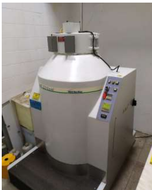
Figura 12 – Irradiador Gammacell utilizado para irradiar as amostras de concreto.
