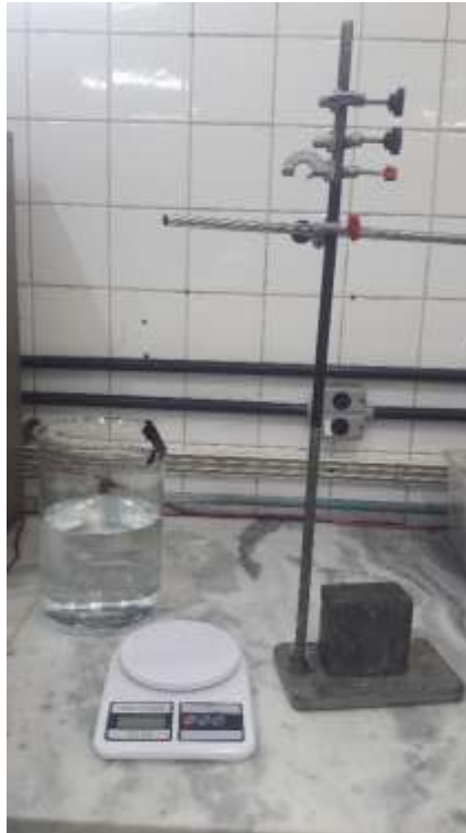
Figura 17 - Aparato experimental para a determinação da massa específica das amostras de concreto.
