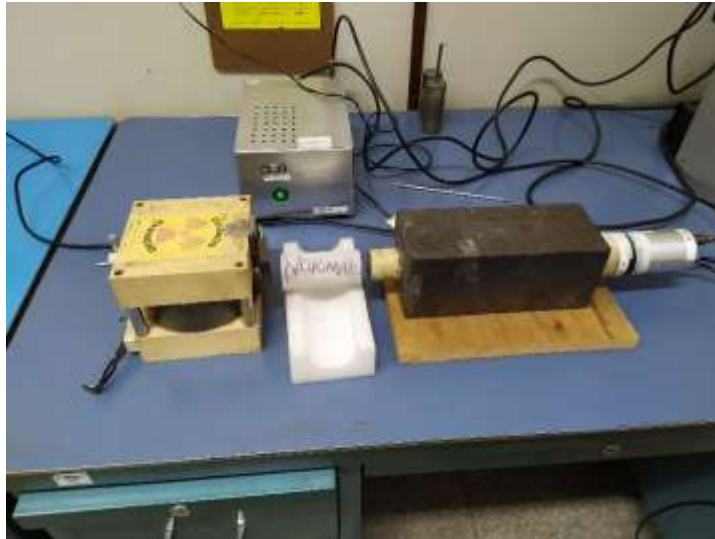
Figura 13 - Aparato experimental montado para a determinação do coeficiente de atenuação para uma energia de 661,66 keV.
