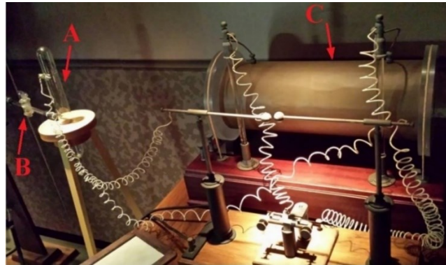
Figura 2.3 — Réplica do primeiro experimento da descoberta de raios X de 1895; (A) Ampola de Crookes; (B) Sistema de vácuo ativo (C) Indutor de Ruehmkorff (BEHLING, 2020).
