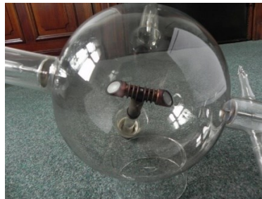
Figura 2.5 — Ampola de íons para imagens estereoscópicas com raios X de 1912 (BEHLING, 2020).
