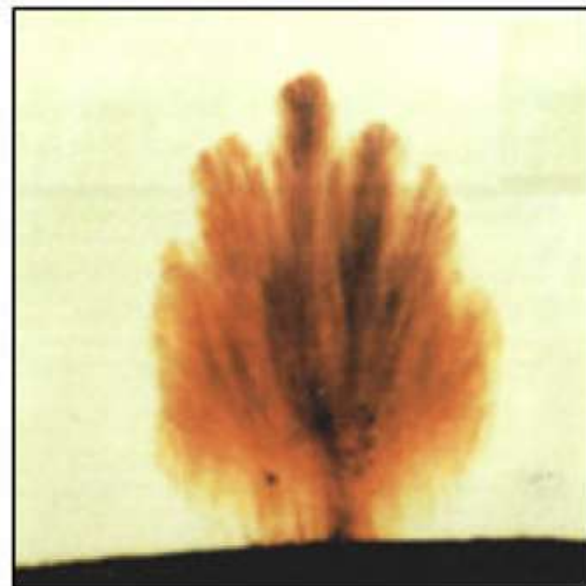
Figura 4.1: Arborescência do tipo vented-tree (LIMA et al. , 2008b).
