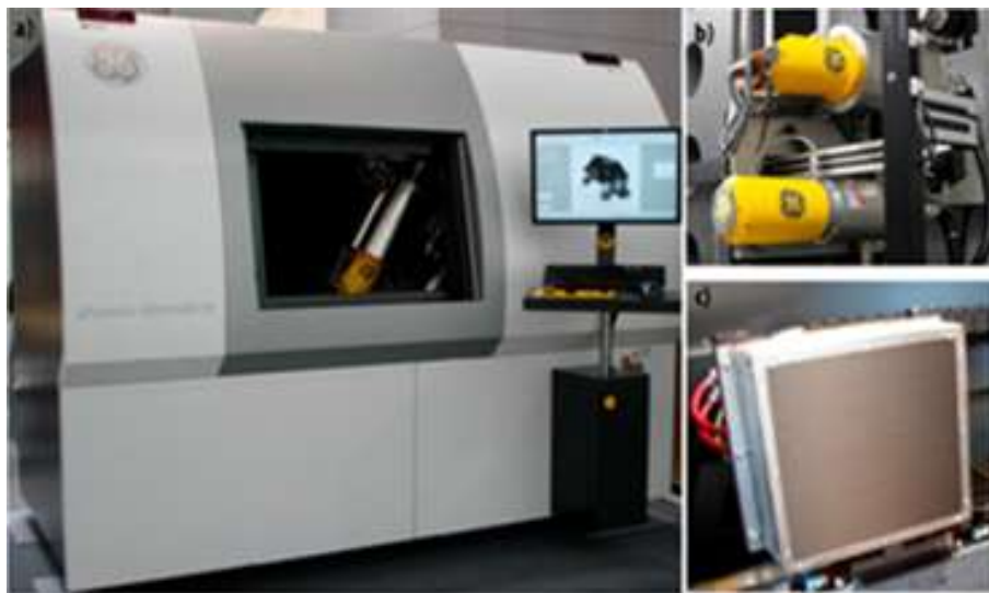
Figura 3.1: (a) Microtomógrafo V|tomex|xm, à direita, o painel de controle para manipulação do corpo de prova e o monitor de vídeo. (b) Imagem da disposição dos dois tubos de raios X similares ao utilizados no sistema B, na parte superior o tubo microfoco e abaixo o tubo nanofoco (c) Imagem do detector Flat Panel no interior do equipamento (DE PAIVA TELES, 2016).
