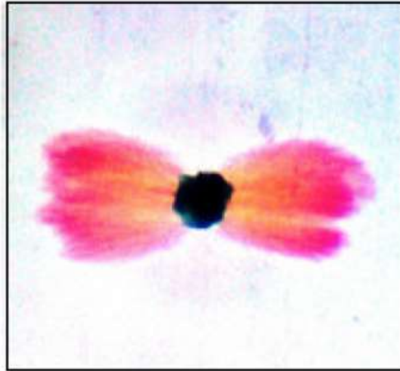
Figura 4.2: Arborescência do tipo bow-tie-tree (LIMA et al. , 2008b).
