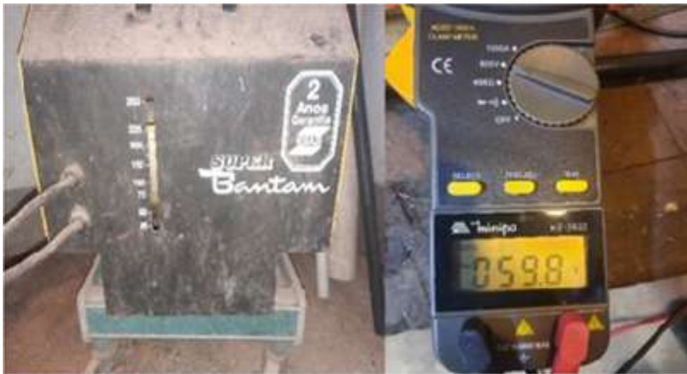
Figura 5.2: Máquina de solda utilizada como fonte de corrente elétrica e tensão de saída da fonte registrada em alicate amperímetro.
